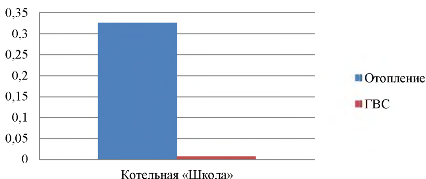
Рисунок 4. Распределение суммарных тепловых нагрузок по котельной с. Малая Камала
